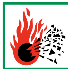
Thermique ou pouvant provoquer un incendie ou une explosion
